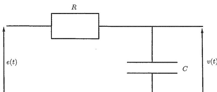
Le circuit est alimenté par une tension « source » représentée par une fonction  $e$ . La tension aux bornes du condensateur est représentée par une fonction  $v$ . Si on considère cette tension comme signal de « sortie », le circuit joue le rôle de filtre passe-bas.
