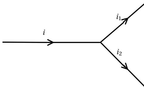
Le courant initial  $i$  et les deux courants résultants  $i_1$  et  $i_2$  ont la même pulsation  $\alpha$ . Si  $i_k = \widehat{I}_k \sin(\alpha t + \varphi)$ , alors, en notant  $I_k$  la valeur efficace<sup>k</sup> de  $i_k$  on a
