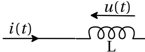
Par définition de l'intensité  $i(t)$ , on a  $u(t) = L \frac{di(t)}{dt}$ . Or  $i(t) = I\sqrt{2}\sin(\alpha t + \varphi)$ , donc
