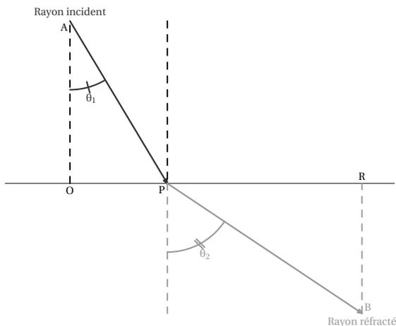
On note  $x = OP$  l'abscisse de  $P$ . On note  $\ell = OR$ ,  $h_1 = OA$ ,  $h_2 = RB$ . On calcule le temps de parcours  $T(x)$  entre  $A$  et  $B$ . Ce temps vaut :
